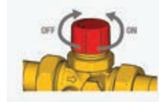
Βαλβίδα ελέγχου ροής σε μεταβαλλόμενη πίεση ON/OFF χειροκίνητα
